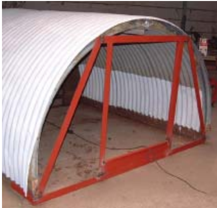
Die Hütte ist zweiwandig mit einer Isolierschicht aus Glasfaser
